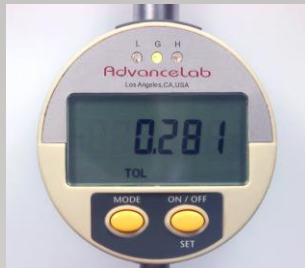
Indicador muestra "Go" Para la medida deseada.
