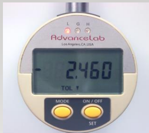
Indicador muestra "L" Para medida muy baja.
