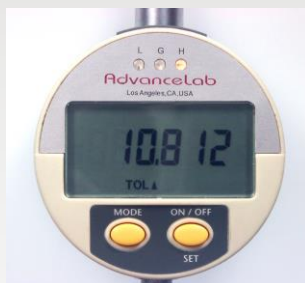
Indicador muestra "H" Para medida muy alta.
